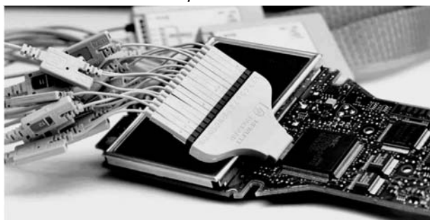
Рис. 6. Переходник для подключения к цифровым ИС
