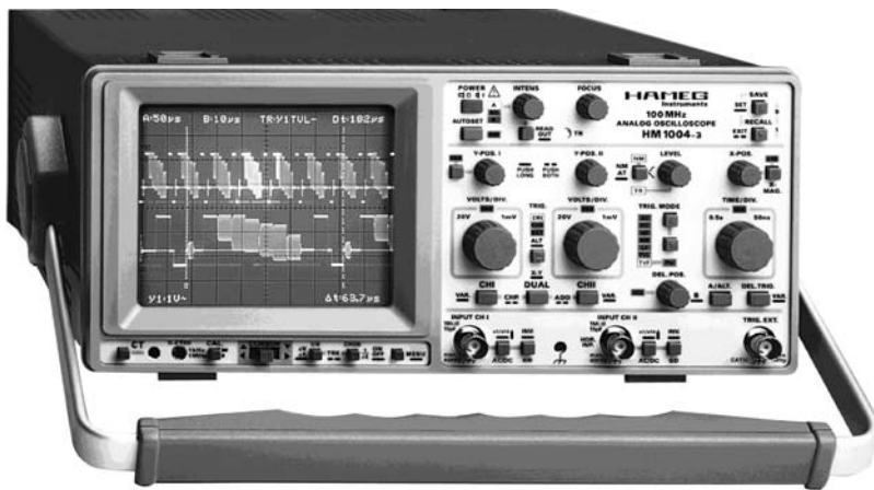
Рис. 1. Внешний вид аналогового осциллографа HM1004-3
