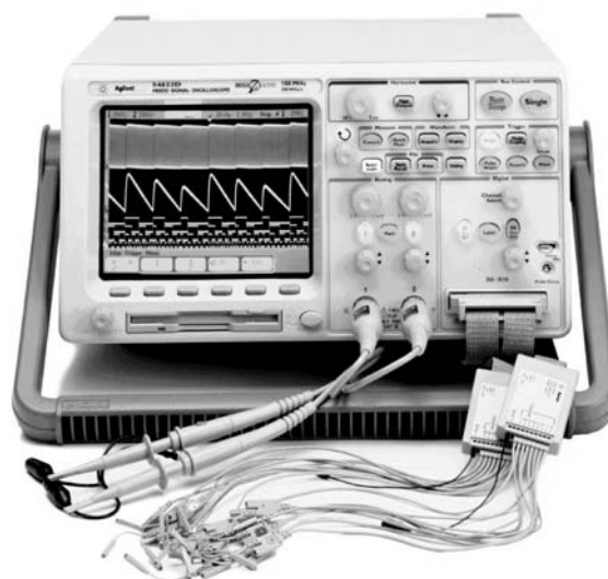
Рис. 2. Осциллограф 54622D для одновременного анализа цифровых и аналоговых сигналов
